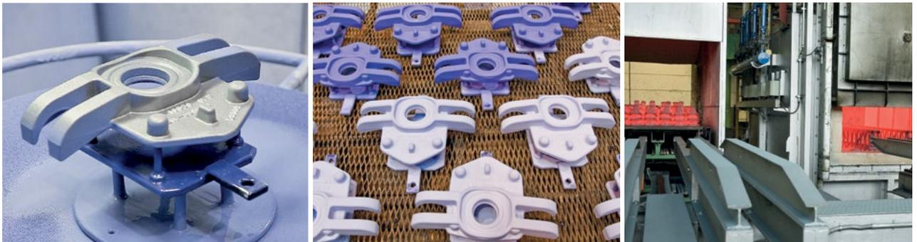
*Nach dem Auftragen trocknet der Schlicker zunächst, bis die optimale Restfeuchtigkeit für den Brennvorgang erreicht ist. Während der Trocknung ändert sich auch die Farbe des Schlickers. Die zwei modernen Brennöfen im Werk Heidenheim ermöglichen eine qualitativ hochwertige Durchführung der Emailierungen.*
