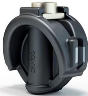
*Der Absperrkeil besteht aus einem Guss-eisenkern und ist komplett mit einer Elastomerschicht für eine weiche Abdichtung ummantelt. Integrierte Gleitschuhe sorgen für eine leichte Betätigung.*
