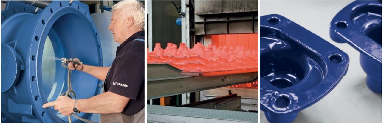
*Insbesondere bei großen Armaturen wie dieser Absperrklappe wird der Emailslicker im Sprühverfahren auf das Metall aufgebracht. Nach dem Brennen im Ofen bei über 700 °C entsteht die gewünschte glasartige, hochfeste Emaillierung im gewünschten Farbton.*
