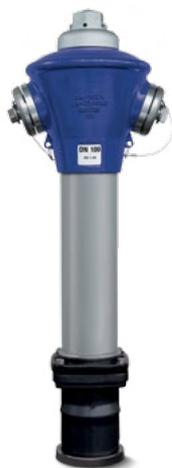
*Der ERHARD City-Hydrant, ein Überflurhydrant mit Sollbruchstelle, einer Edelstahl-Überflursäule sowie allen Konstruktionsmerkmalen des ERHARD Unterflurhydranten, ist im Standard mit einer innen emaillierten Unterflursäule und optional einem vollemaillierten Kopf ausgestattet, der dank der optimalen UV-Beständigkeit auch nach vielen Jahren noch seine ursprüngliche Farbe aufweist.*
